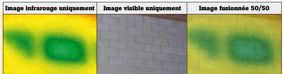
**Figure 1.** L'absence de ciment de remplissage dans un mur en blocs de cendres est repérée avec précision grâce à la fusion des images IR et dans le visible
