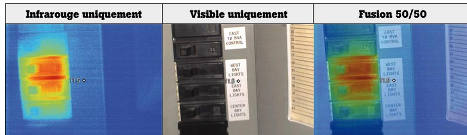
Figure 6. Il est à la fois possible de lire les étiquettes de l'équipement et d'identifier la zone posant problème sur une image infrarouge/dans le visible fusionnée
